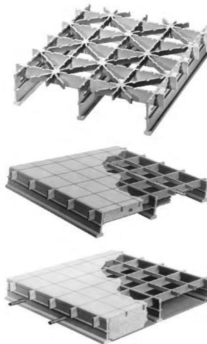
Gambar 6.1 Variasi Dek Jembatan Kisi Baja
