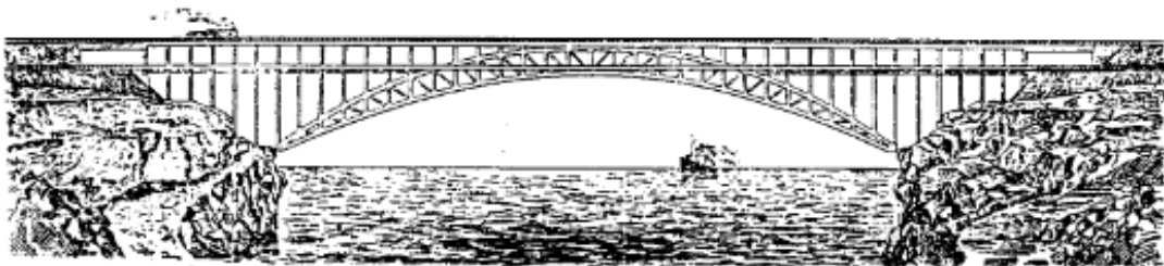
Gambar 5.5 Jembatan Lengkung Baja Dengan Bentang 224 M.
