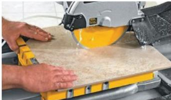
Gambar 6.10 Gergaji basah kelas komersial ideal untuk memotong semua jenis ubin dan batu dalam aplikasi kolam renang, air mancur, atau fitur air.
