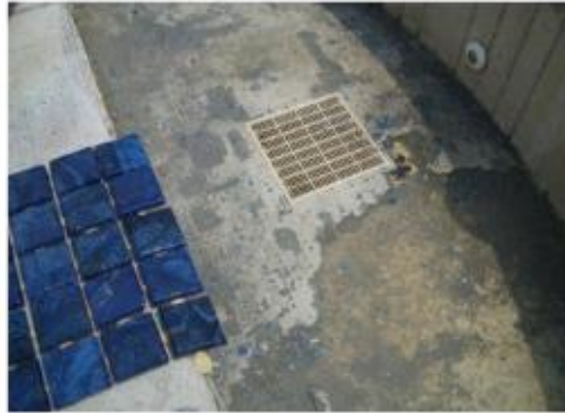
Gambar 11.6 Meningkatnya penggunaan bak mandi prefabrikasi (misalnya, fiberglass atau baja tahan karat) memerlukan penggunaan perekat epoksi 100% padat (misalnya, Perekat LATAPOXY 300). Dalam hal ini, mortar tipis berbahan dasar semen Portland yang diperkuat lateks digunakan di atas bak mandi fiberglass yang mengakibatkan kegagalan ikatan.
