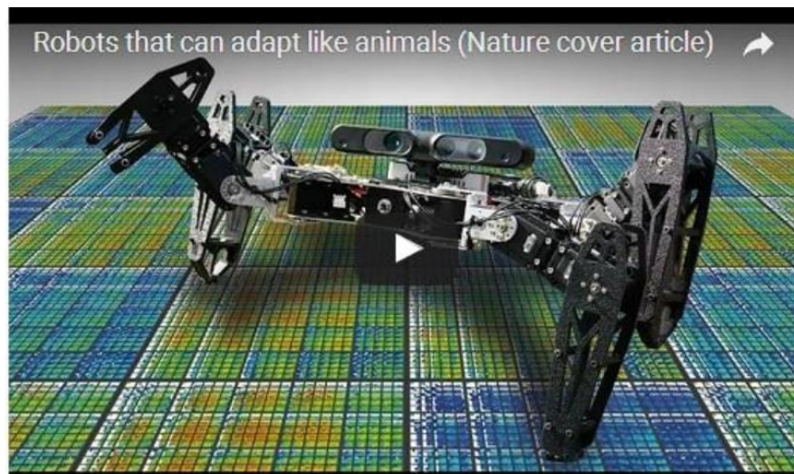
Gambar 4.7 Algoritma Coba-Coba Cerdas Yang Diperkenalkan Dalam Makalah 'Robot Yang Dapat Beradaptasi Seperti Hewan' —Video Tersebut Menunjukkan Dua Robot Berbeda Yang Dapat Beradaptasi Dengan Berbagai Macam Cedera Dalam Waktu Kurang Dari Dua Menit.
