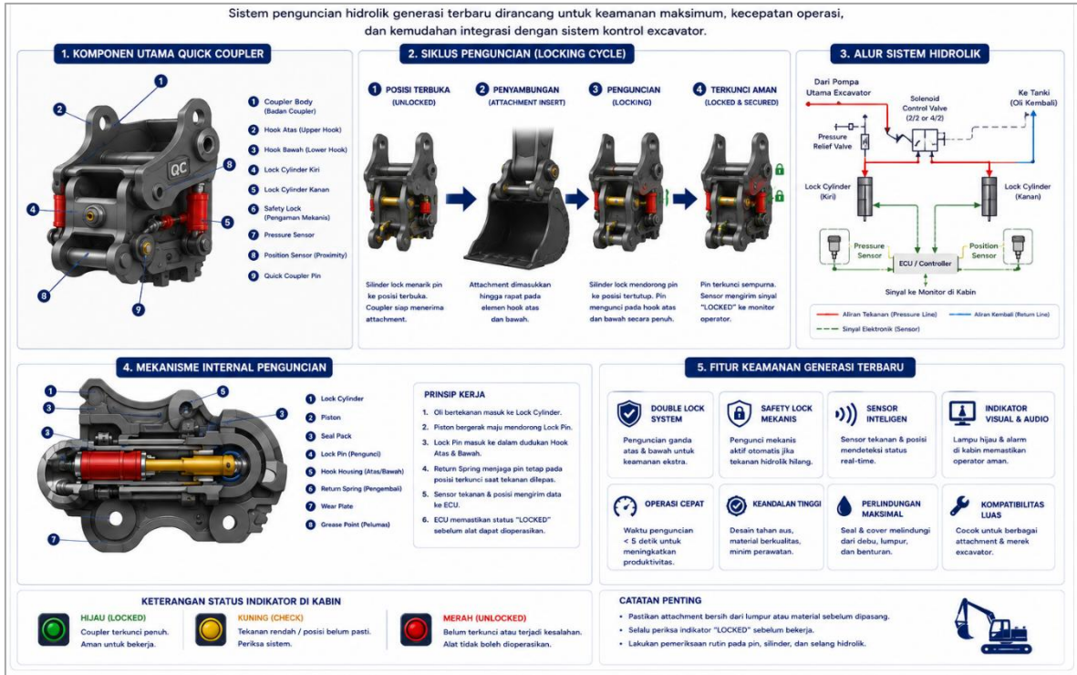
Gambar 10.7 Mekanisme Penguncian Hidrolik pada Quick Coupler Generasi Terbaru
