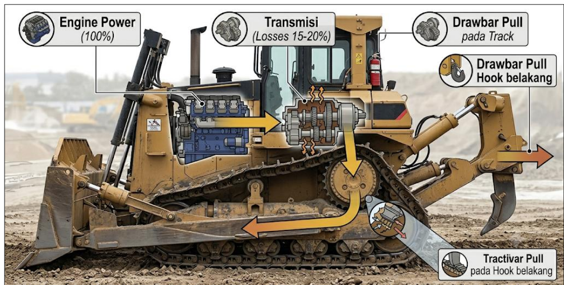
Gambar 3.2 Skema Penyaluran Tenaga pada Bulldozer
