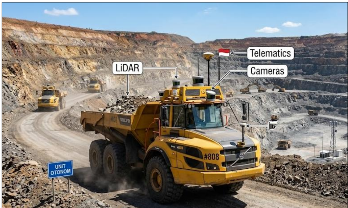
Gambar 16. 7 Unit Autonomous Dump Truck Tanpa Kabin Pengemudi Yang Sedang Beroperasi
