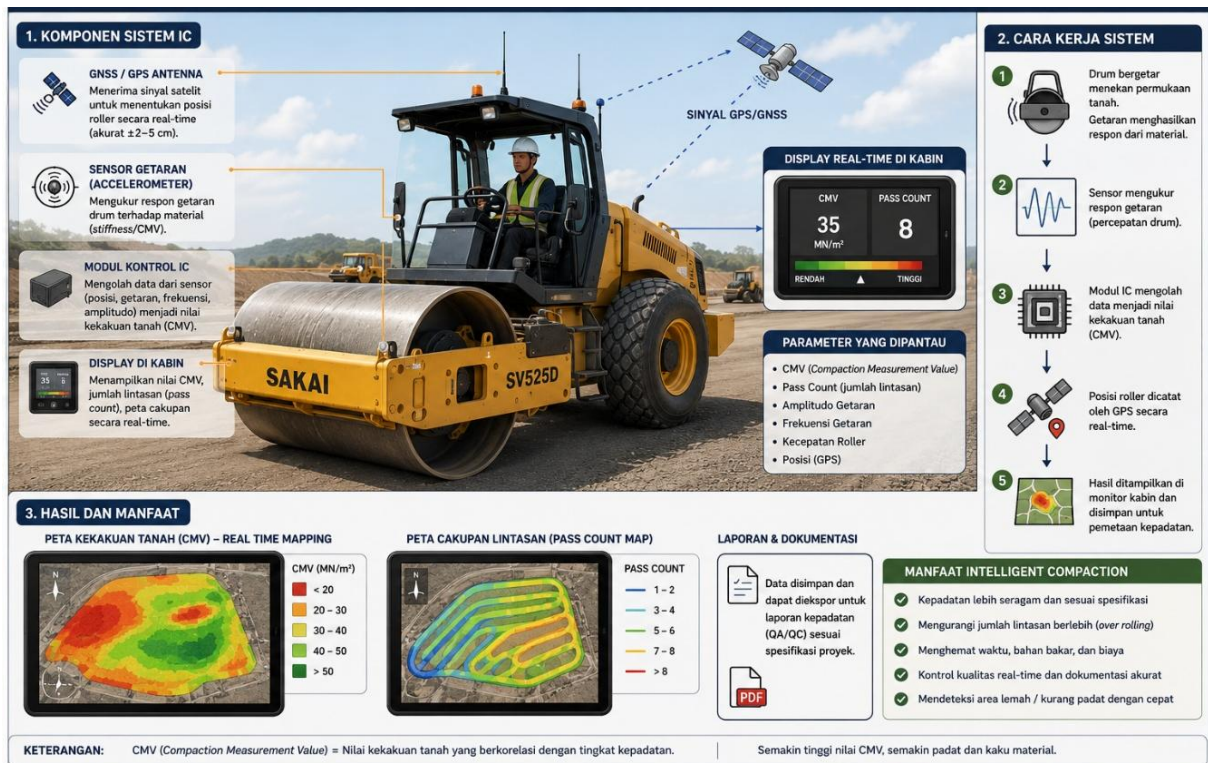
Gambar 8.6 Penggunaan Teknologi Intelligent Compaction
