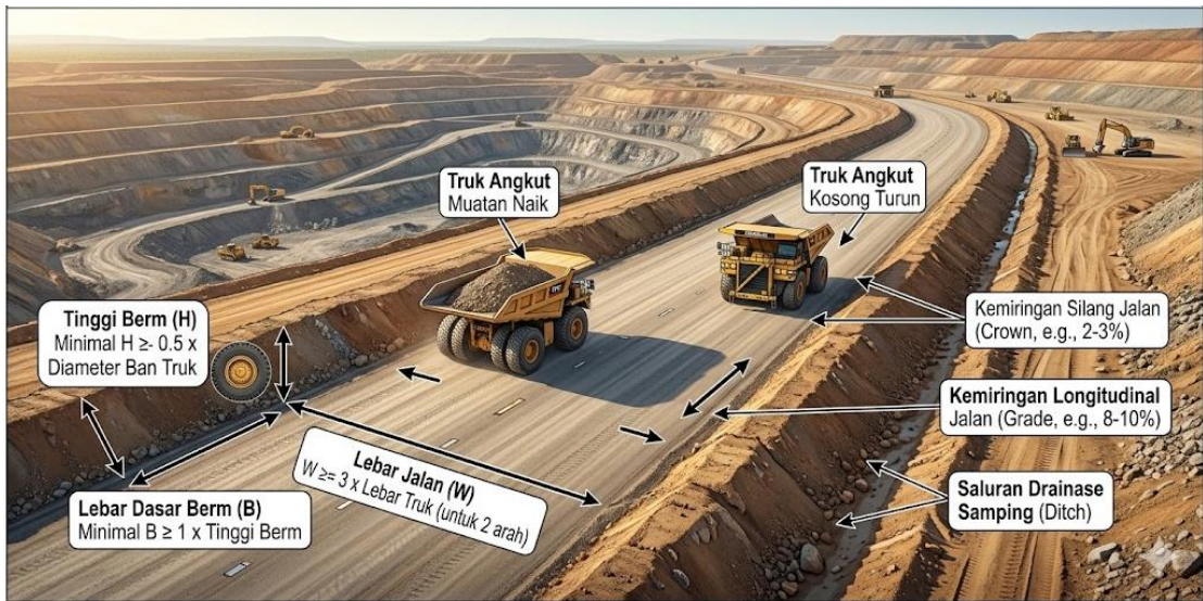
Gambar 13. 6 Desain Jalan Angkur Yang Ideal
