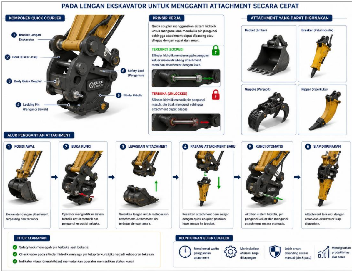
Gambar 9.7 Mekanisme Penguncian Quick Coupler
