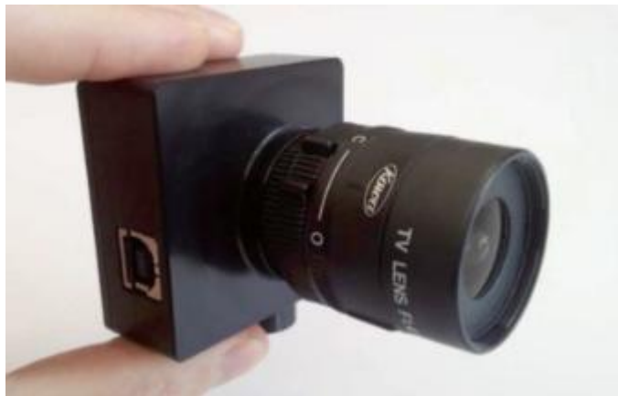
Gambar 2.3. Kamera berbasis peristiwa 680 x 480.
