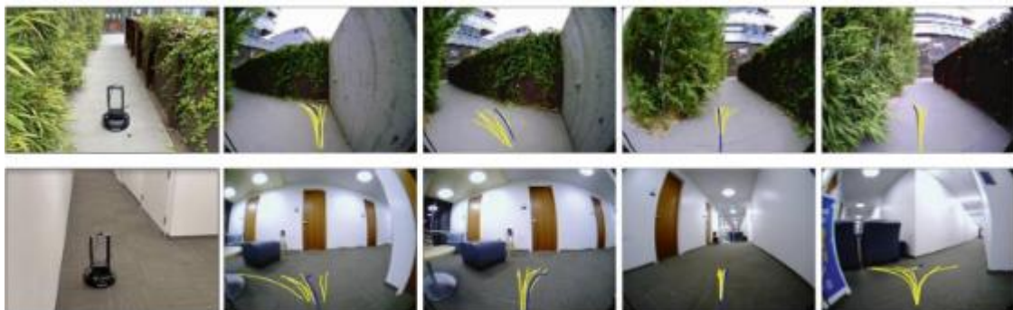
Gambar 6.18. Peluncuran NoMaD di lingkungan dalam ruangan (atas) dan luar ruangan (bawah). Garis kuning adalah sampel tindakan masa depan dari mode tak terarah dan garis biru menunjukkan tindakan yang dipilih oleh perencana tingkat tinggi.
