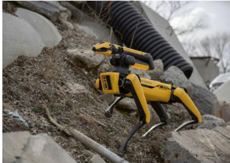
Gambar 7.1. Robot titik Boston Dynamics yang dilatih untuk berjalan di medan kasar melalui pembelajaran penguatan. Robot modern sering diajarkan untuk berjalan melalui pembelajaran penguatan, dan Boston Dynamics bukanlah satu-satunya perusahaan yang melakukannya.
