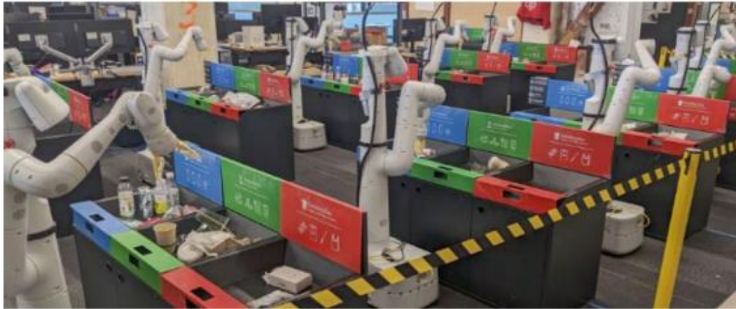
Gambar 7.12. Pemilahan sampah skala besar oleh robot bergerak dari Google dan Everyday Robots. Dua puluh tiga robot dikerahkan untuk melakukan pemilahan sampah selama dua tahun.
