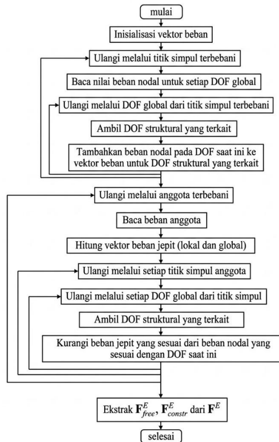
Gambar 8.20 Diagram alir untuk penyusunan vektor beban.
