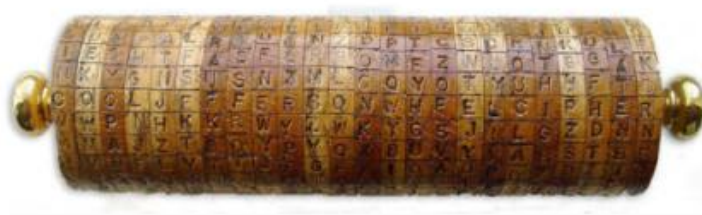
Gambar 3.3 Contoh silinder Jefferson yang digunakan sebagai sandi polialfabetik. Setiap cakram memuat permutasi huruf-huruf alfabet. Pada satu baris, pesan teks asli ( plaintext ) ditampilkan ("COOL JEFFERSON WHEEL CIPHER"); baris lainnya dapat digunakan sebagai pesan terenkripsi yang mudah dipecahkan oleh siapa pun yang memiliki silinder Jefferson dengan urutan cakram (permutasi alfabet) yang sama. Gambar diambil dari https://www.monticello.org/research-education/thomas-jefferson-encyclopedia/wheel-cipher/
