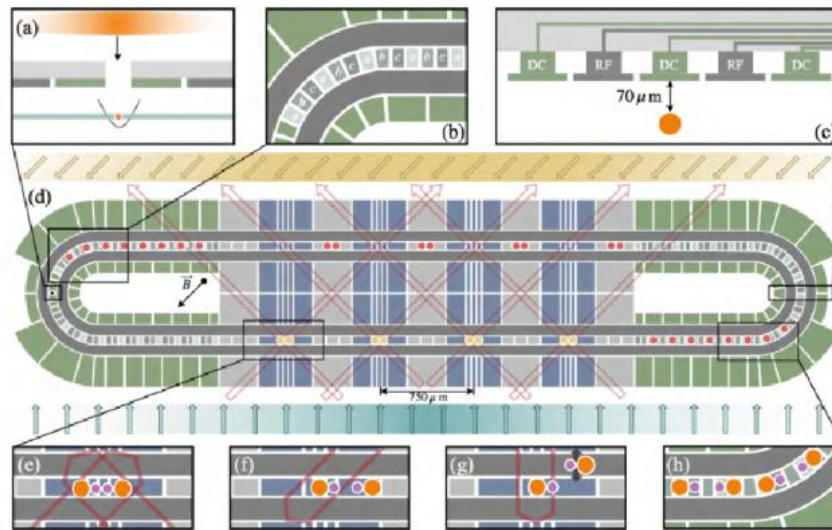
Gambar. 5.2 Jalur lintasan ( race track ) pada cip Quantinuum. Ion-ion tetap berada di zona hijau ("area memori" komputer kuantum), tempat mereka kemudian dipindahkan ke zona biru untuk menjalankan gerbang logika yang diperlukan bagi komputasi kuantum.
